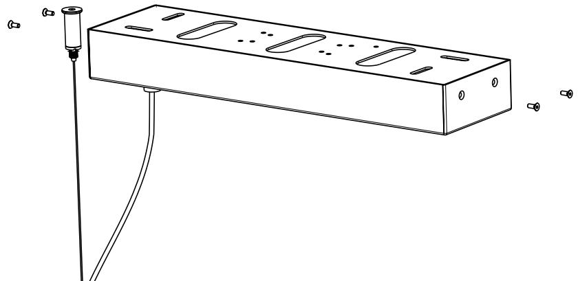
⑫ Fissare il rosone mediante le quattro viti laterali.
