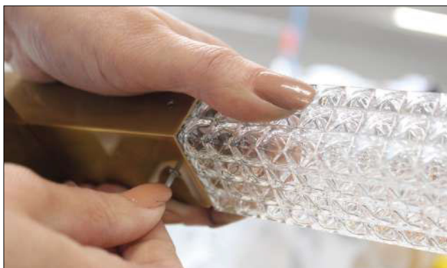
5. Screw the grain on the back. Stringere il grano sul lato posteriore.
